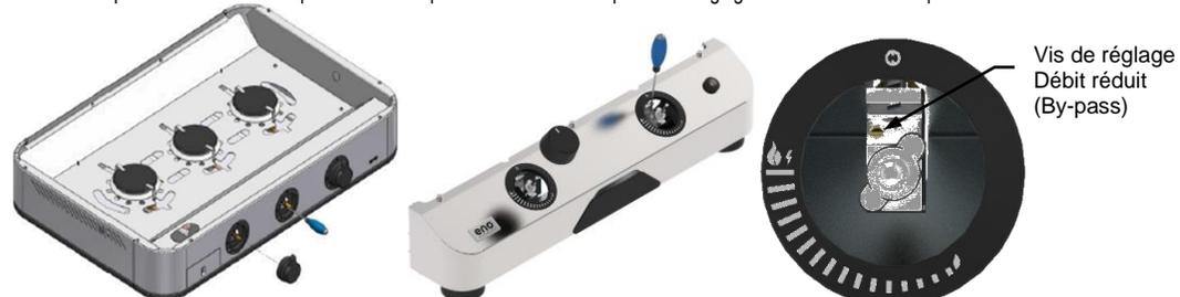
NOTA : L'étiquette changement gaz (fournie avec les injecteurs) doit être collée sur la plaque signalétique de la plancha lors du changement gaz.
